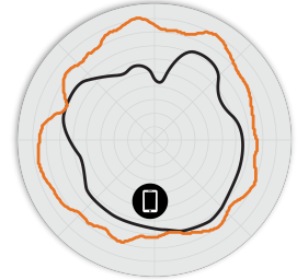
Attēls 7. R770 6GHz Elevation antenu paterns
