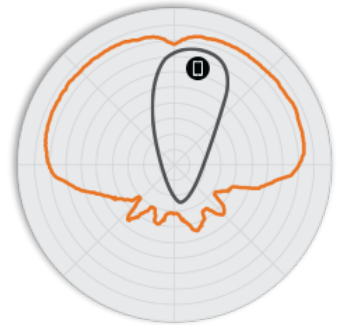
РИСУНОК 5 Вертикальная плоскость 5 ГГц H320 Диаграммы направленности антенны
