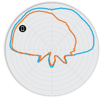
РИСУНОК 5 Вертикальная плоскость 5 ГГц R730 Диаграммы направленности антенны
